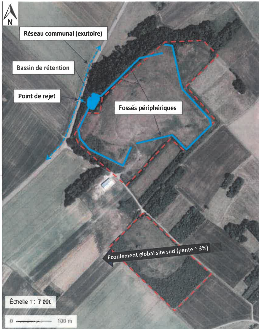
Figure 53 : Schéma de la gestion des eaux pluviales sur le site d'étude
