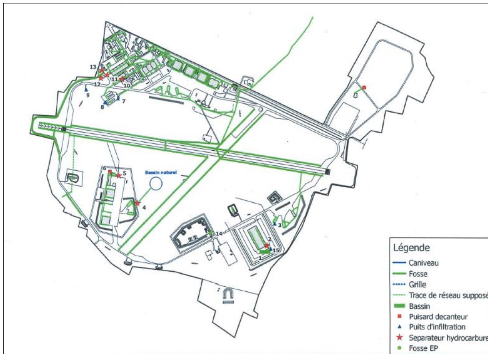
Figure 7 : Synoptique du système de collecte des eaux pluviales (Source : SETEC HYDRATEC, avril 2017)
