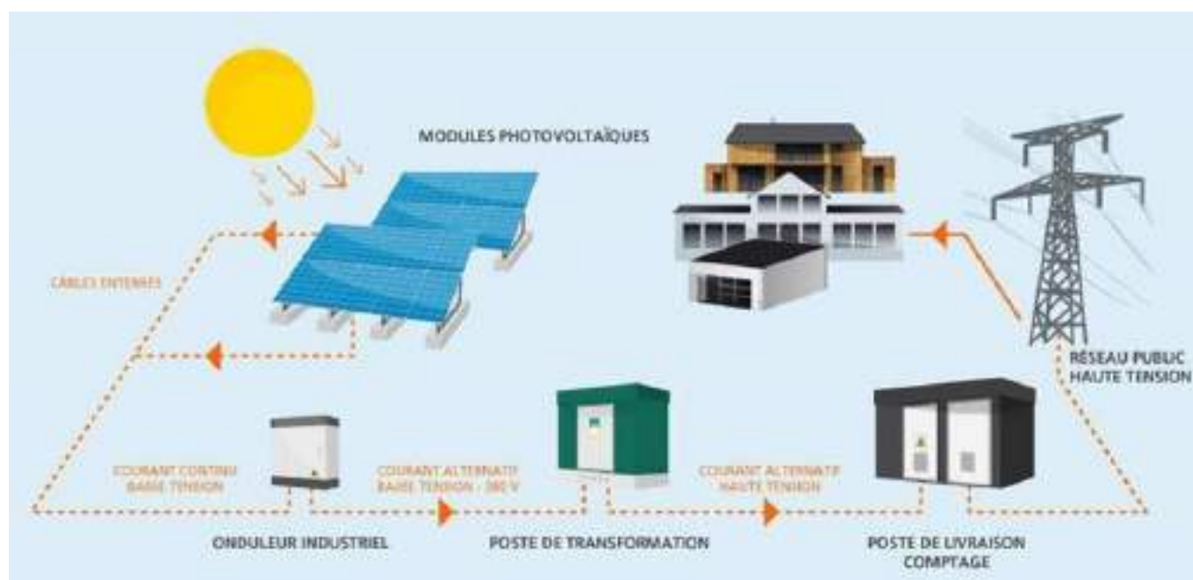
Figure 26 : Principe du raccordement électrique d'une installation photovoltaïque
