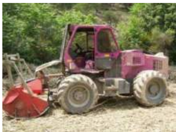
Figure 37 : Exemple de tracteur équipé d'un broyeur forestier Source : Société forestière de la Durance, 2016
