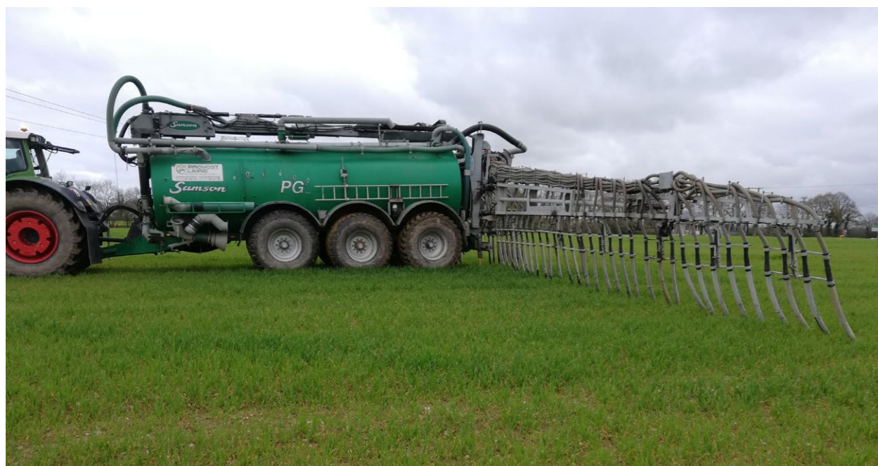
Épandage de digestat liquide au pendillard
