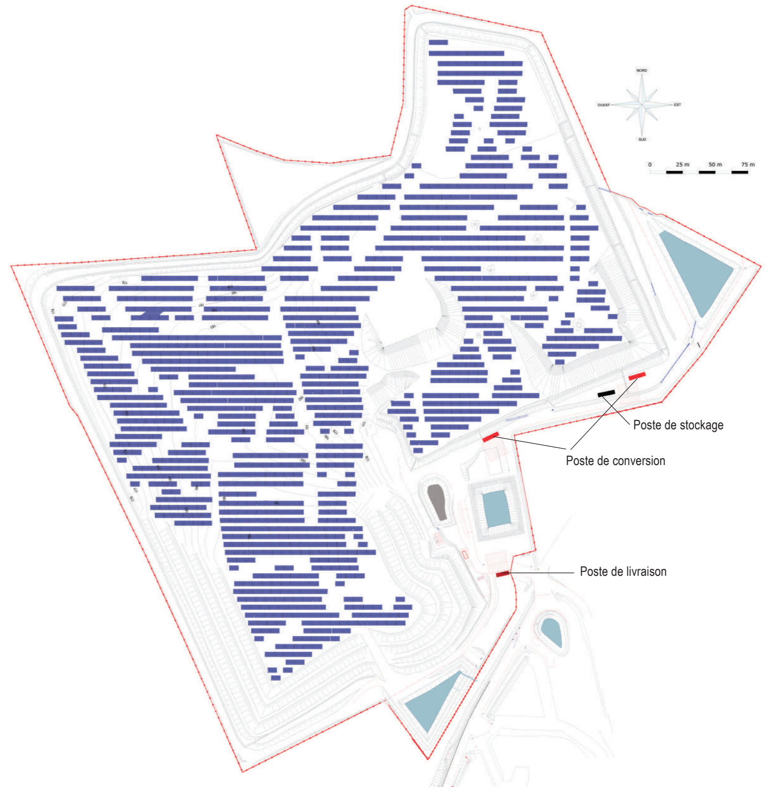
Plan d'implantation des panneaux photovoltaïques sur le site. Le projet tient compte de la végétation existante à préserver et des masques produits par les boisements alentours ou par le relief. Les éléments techniques sont implantés en partie basse du site à l'Est de la parcelle.
