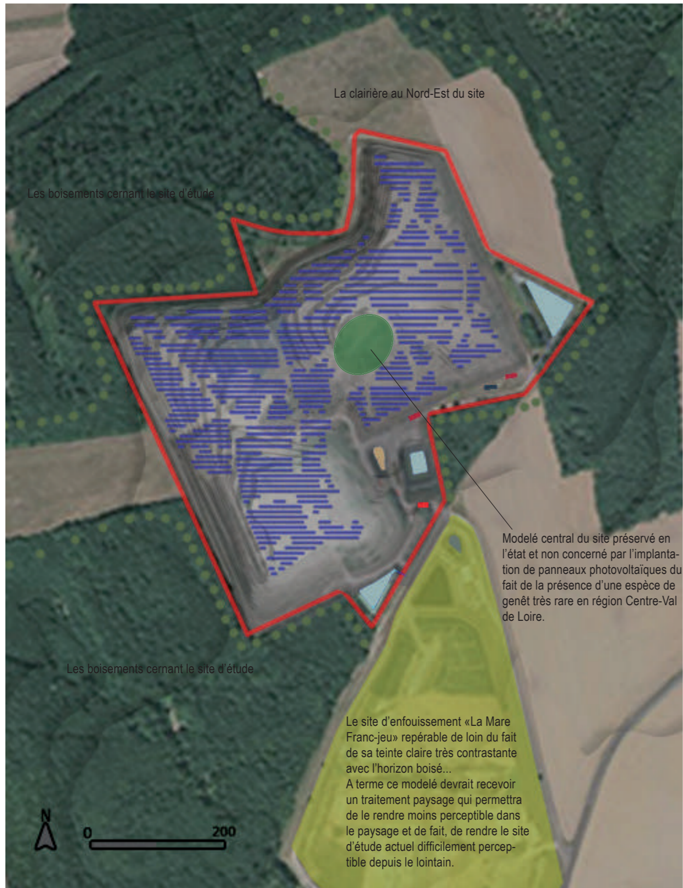
Plan d'implantation des panneaux photovoltaïques sur le site. Le projet tient compte de la végétation existante à préserver et des masques produits par les boisements alentours ou par le relief. Les éléments techniques sont implantés en partie basse du site à l'Est de la parcelle.
