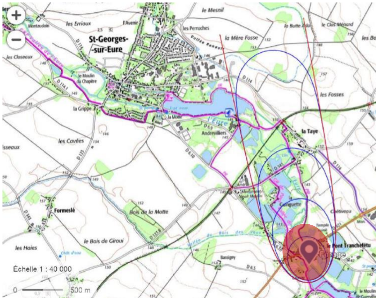
Figure 10. Zone appel et isochrones autour du site de Launay en pompage à 200 m 3 /h (d'après
