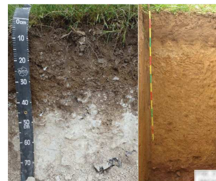
Photo 1 : Exemple à gauche, d'un calcosol sur craie observé à Ézu-sur-Eure (Eure), et à droite d'un néoluvisol sur micaschistes
