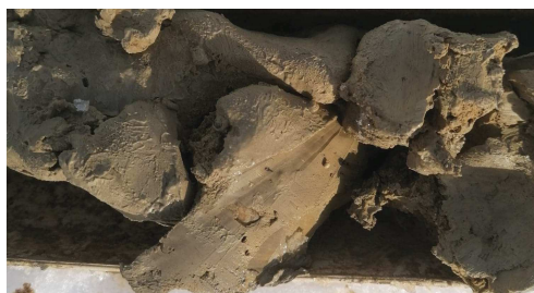
Photo 9 : Exemple de sol rédoxique avec traces de rouille caractéristiques (sondage n°5)
