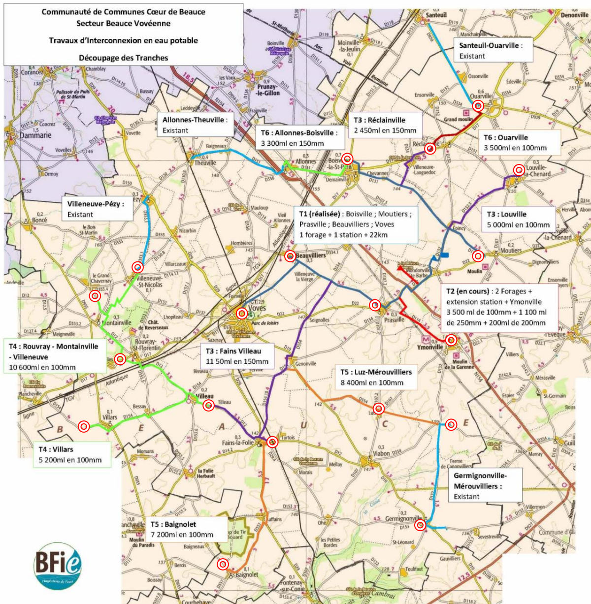
Figure 8. Plan du réseau d'interconnexions – châteaux d'eau
