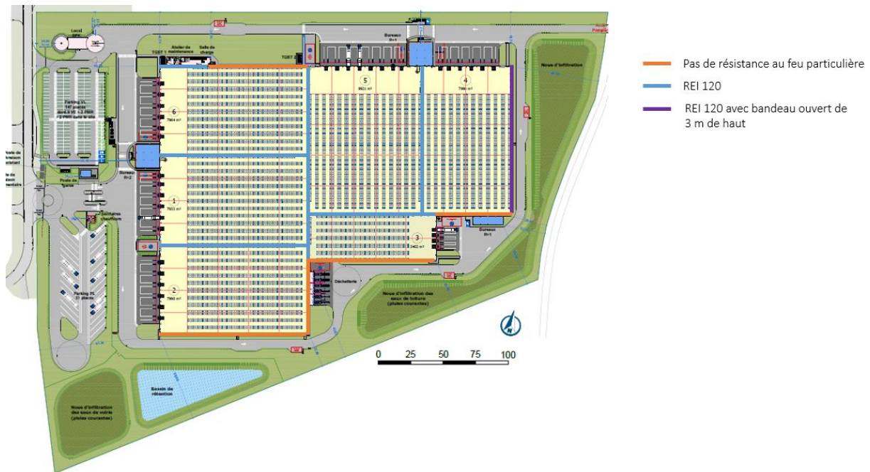
Figure 11 : Plan des murs coupe-feu de la plateforme
