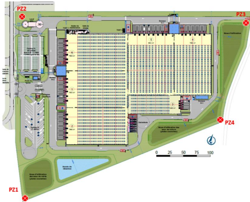
Figure 22 : Emplacement des piézomètres prévus
