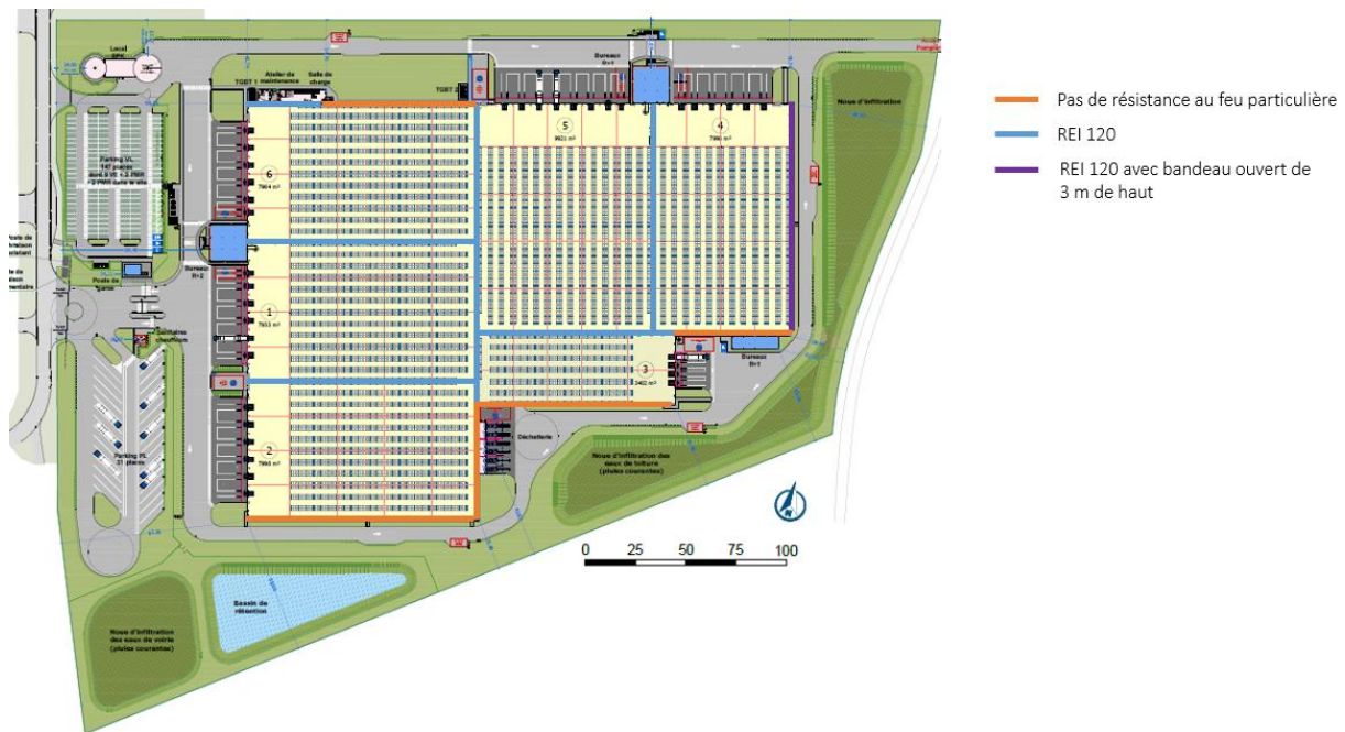
Figure 36 : Plan des murs coupe-feu
