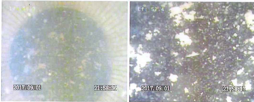
Figure 6 : Dépôt présent au fond du forage
