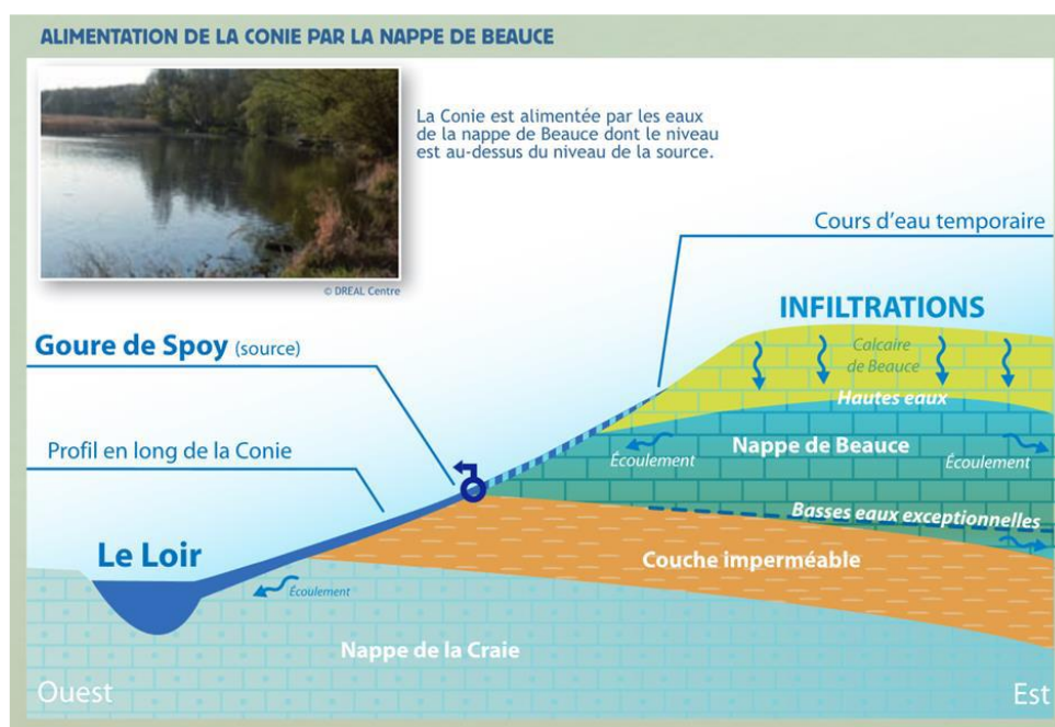
Figure 11. L'alimentation de la Conie par la nappe de Beauce (source : CSSTI Centre-Sciences [17]).
