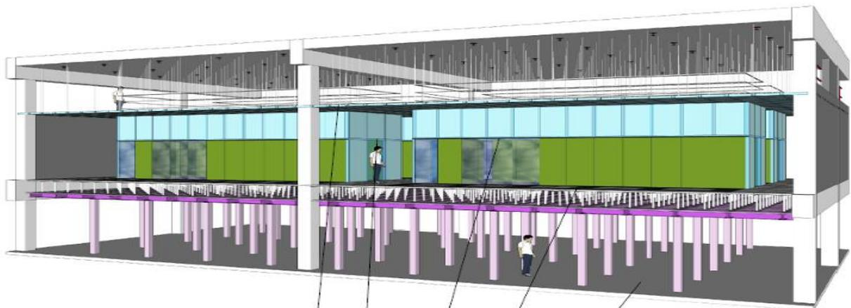
UN FAUX-PLAFOND FERME AU DESSUS DES ALLEES FROIDES AVEC DES GARDE-CORPS POUR MAINTENANCE TECHNIQUE EN DALLE HAUTE DE LA SALLE
