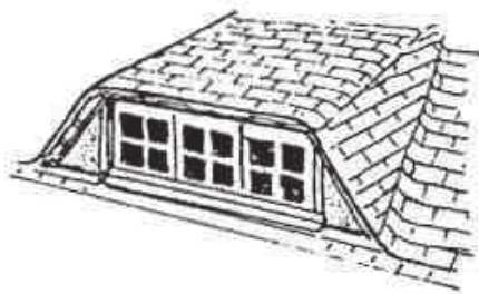
lucarne en trapèze (couverture en bardeaux d'asphalte)
