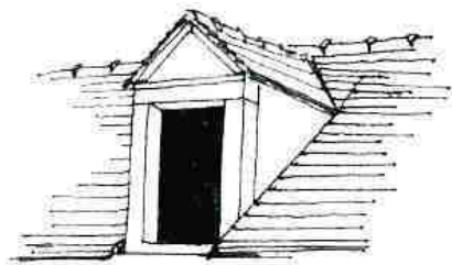
Figure 8 / Lucarne au dessus de l'égout.
