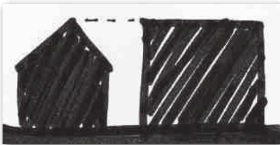
Figure 75 / La hauteur des constructions est mesurée à partir du point le plus bas du terrain naturel initial au droit de la construction jusqu'au faîtage.
